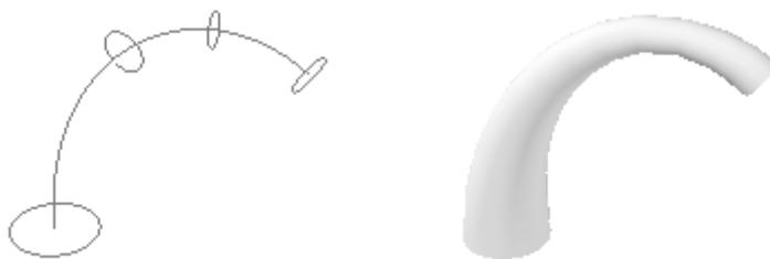
Figura 42. Secciones transversales y sólido solevado
