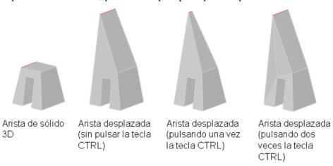
Cuando desplaza, gira o aplica una escala a una arista sin pulsar CTRL, la arista se modifica junto con sus vértices, manteniendo la longitud de la arista, pero cambiando posiblemente los planos de las caras planas advacentes a los vértices de la arista.
