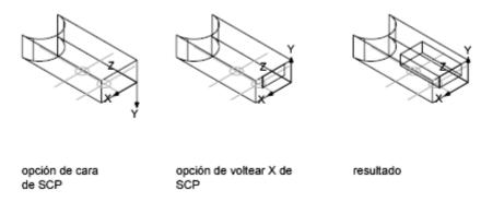
Figura 7. Alineación del SCP con una cara del sólido
