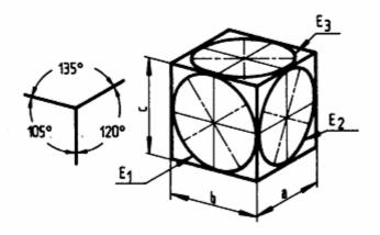
Figura 31. Perspectiva trimétrica según normas IRAM
