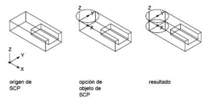
Figura 8. Alineación del SCP con objeto existente
