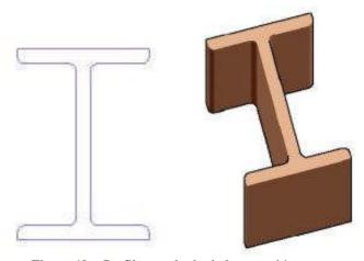
Figura 40. Perfil y resultado de la extrusión
