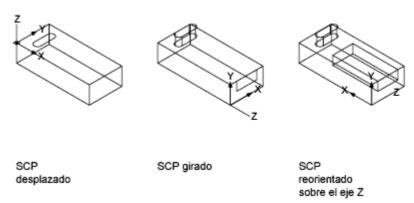
Figura 5. Desplazamiento, giro y reorientación del SCP
