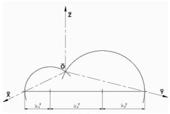
Figura 25. Trazado de ejes axonométricos
