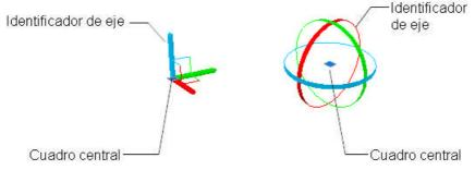
Al designar objetos en primer lugar y, a continuación, hacer clic en un identificador de eje y empezar a mover los objetos designados, puede pulsar la BARRA ESPACIADORA para cambiar a la herramienta de pinzamiento de rotación. Puede volver a pulsar la BARRA ESPACIADORA para volver a la herramienta de pinzamiento de desplazamiento. Cuando se cambian herramientas de pinzamiento de este modo, el movimiento queda restringido al eje designado.
