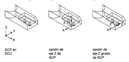
Figura 11. Especificación de eje Z del nuevo SCP
