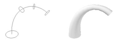
Figura 42. Secciones transversales y sólido solevado
