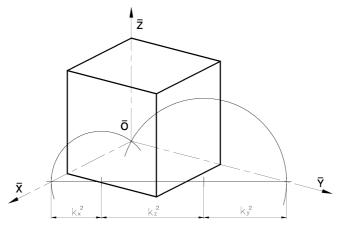
Figura 26. Dibujo axonométrico del cubo de referencia
