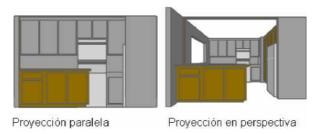
Figura 17. Comparación proyección central y paralela
